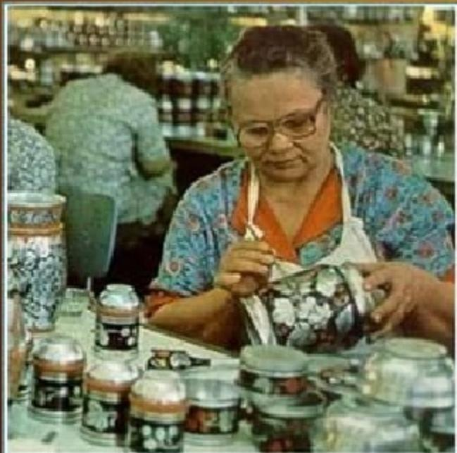
После этого покрывают специальным металлическим порошком и расписывают красивыми узорами.
